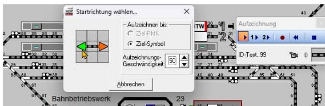
Abb. 7.41 Auswahl der Startrichtung für die halbautomatische Fahrstraßenaufzeichnung
