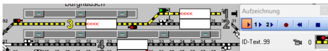
Abb. 7.43 Die Fahrstraße wurde bis zum Zielsignal aufgezeichnet und alle Magnetartikel zeigen die korrekte Stellung an
