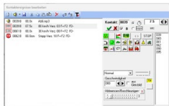
Abb. 7.144 Den Kontakten der Fahrstraße sind insgesamt vier Kontakt ereignisse zugeordnet
