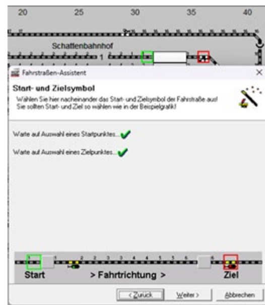
Abb. 7.121 Die Auswahl des Start- und Zielpunktes für eine Aufrück-Fahrstraße
