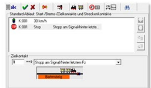
Abb. 7.125 Fahrtverlauf einer Aufrück-Fahrstraße
