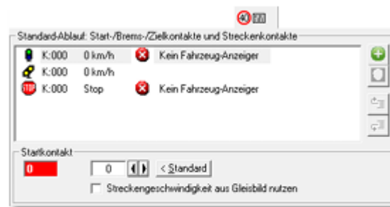
Abb. 7.92 Fehleinträge werden rot markiert dargestellt
